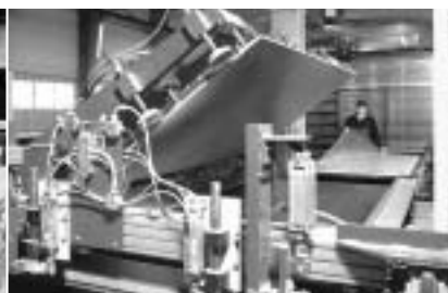
Figure 1.3 : Relevage entièrement automatique des plaques hors des moules de coffrage
