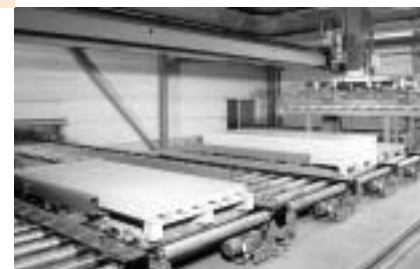
Figure 1.4 : Empilage des plaques sur les palettes
