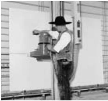
Figure 3.1 : Découpe des panneaux au moyen d'une scie à panneaux
