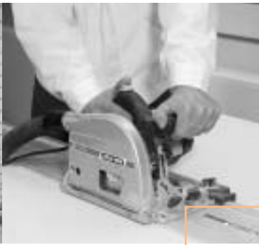
Figure 3.2 : Scie circulaire portative guidée par un rail
