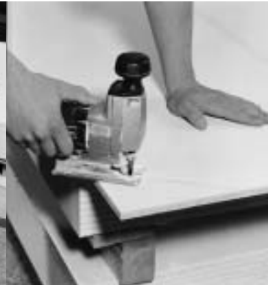
Figure 3.4 : Utilisation d'une scie sauteuse pour les arrondis et adaptations
