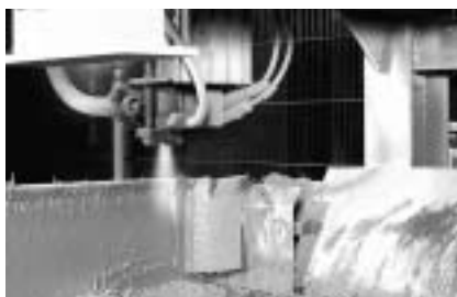
Figure 1.2 : Projection de la couche de couverture inférieure
